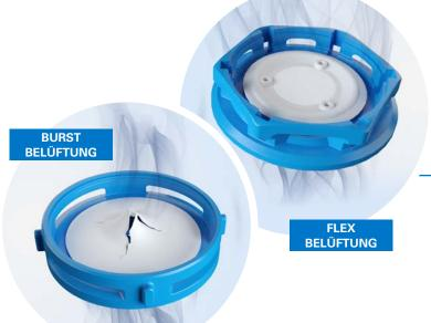
Im Falle eines raschen Druck- und Wärmeaufbaus hilft die zweite Stufe, den Druck im Inneren des Gehäuses durch das Entweichen von Gasen aufrechtzuerhalten, indem sie entweder die Membran mit dem Schirmflex umgeht oder die Membran zum Platzen bringt.
