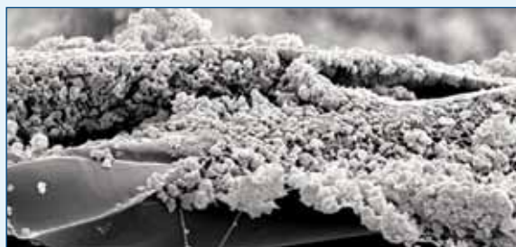
Carga de Polvo en Superficie del Medio Filtrante Ultra-Web (Parte interior del medio sigue limpio)
