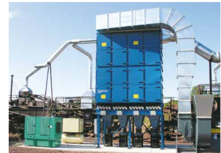
DLMC - 岩石破碎 (1,160 m 3 /min)
