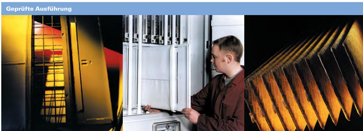
Die flachen Filtertaschen sind für stärkere Belastung und längere Lebensdauer auf biegesteife Drahtgitter-Stützrahmen aufgezogen. Für besondere Anwendungen, z. B. temperaturresistente Einsätze, stehen spezielle Filterstoffe und Spezial-Filtermedien für die Dalomatic-Modellreihen zur Verfügung.
