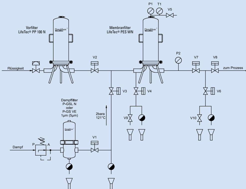
**(1)** Ventile V4, V6, V7, V9 und V10 öffnen.
