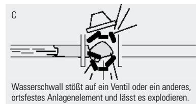
Kondensat sollte im Gesamtsystem vermieden bzw. umgehend entfernt werden, um die Gefahr von explodierenden Ventilen zu vermeiden.
