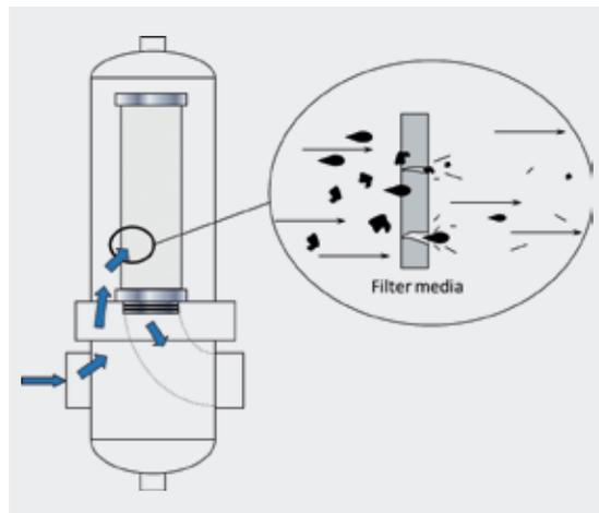
Bei einer Dampfgeschwindigkeit in der Rohrleitung von 20 m/sec treffen Partikel und Teilchen (z.B. Rostpartikel) mit einer Geschwindigkeit von 72 km/h auf das Steril-Filtermedium. (30 m/sec entsprechen einer Geschwindigkeit von 108 km/h).
