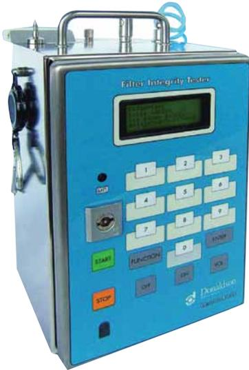
Das Membra-Check Integritätstestgerät kommt für hydrophobe und hydrophile Membranfilter zum Einsatz
