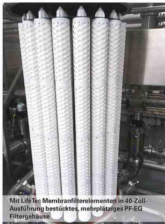
Mit LifeTec Membranfilterelementen in 40-Zoll-Ausführung bestücktes, mehrplätziges PF-EG Filtergehäuse
