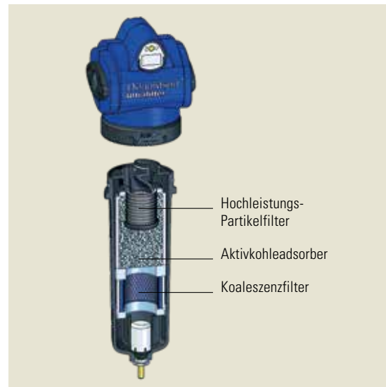
Querschnitt des Ultra-Filters mit einem DF-T Element
