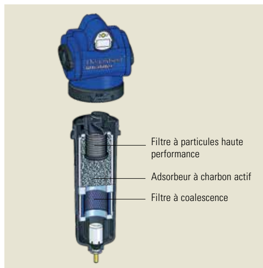
Coupe de l'élément filtrant Ultra-Filter DF-T
