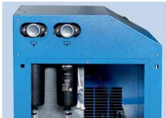
Alle Anschlüsse befinden sich auf einer Seite des Geräts, somit ist eine einfache Installation garantiert
